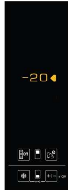
Sonde t° évaporateur en court-circuit
