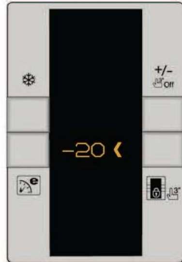
Sonde t° évaporateur en court-circuit
